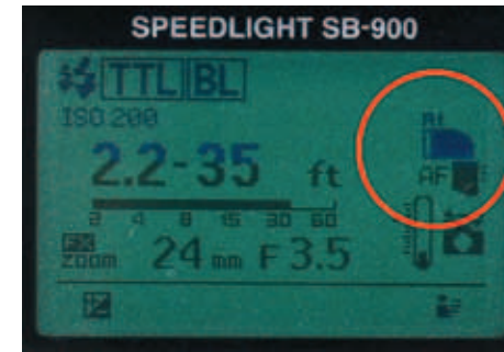
Abbildung 11.29: Überprüfen Sie auf dem Display des Blitzgerätes, ob die Filterfolie erkannt wurde.
