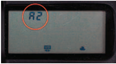
Abbildung 11.5: Das Display der D300 mit der Weißabgleichseinstellung »A2«: Die Farbwerte werden nach Orange verschoben.
